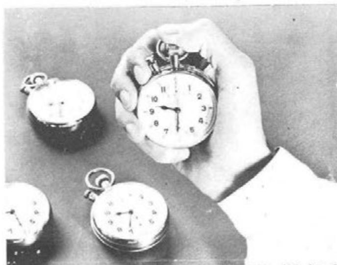
*MG 1155 Cronógrafo de dobles segunderos Omega. 1/10 de segundo de un pulsador. Máquina de 21 rubies, de 53.7 mm. de diámetro. Duración de marcha 36 horas. La manecilla trotadora da una vuelta de esfera en 60 segundos, y los minutos son además registrados por un contador de 0-30 minutos. Manecillas de los segundos, minutos y horas.*
